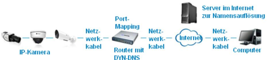
Figure 2-2 Verbinden Sie die Netzwerkkamera über einen Router mit dynamischer IP-Adresse
