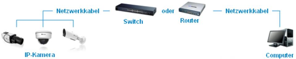
Bild 2-1-2 Verbinden Sie sich über einen Switch oder einen Router
